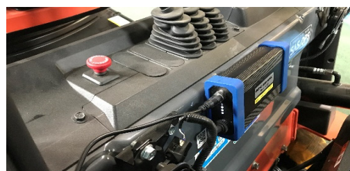
フロントパネル部への モバイルバッテリー設置例
