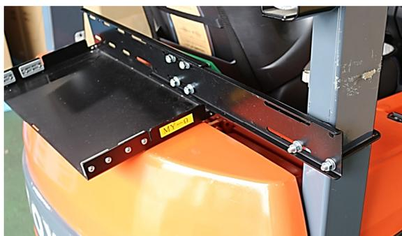
5、コの字ボルトを右側ピラーに2本取付け、仮締めする。
