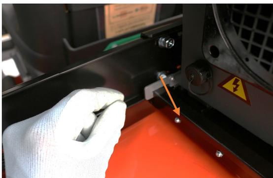
10、左右ストッパーを外側上に引き上げながら後部にスライドさせ、中間で下げれば固定です。
