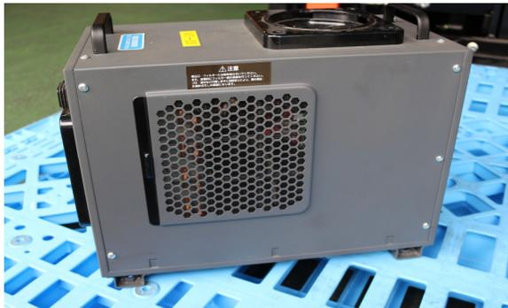
3、DCクーラー本体の脚を4本取外し、上部受け皿に付属の皿ボルト4本で固定する。
