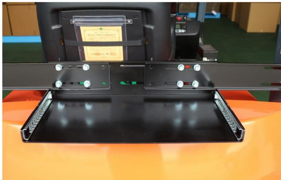
6、左側ピラーにスライドバーを調整し、位置を決めボルト4本で仮締めする。
